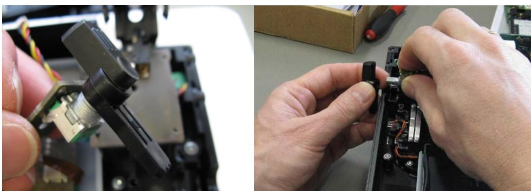
5. Seitenschieberplatine wieder einsetzen und anschrauben. Gehäuse schließen.
